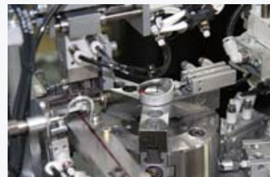
Установка стальной втулки
